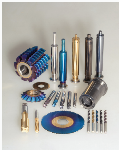
Za industrijske partnerje nanašamo šest različnih trdih prevlek na rezalna in preoblikovalna orodja.
