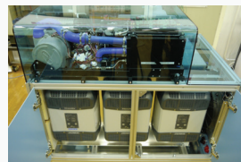
8 kW električni agregat na PEM gorivne celice.
