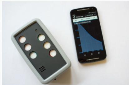
Prenosna senzorska naprava in mobilna aplikacija za spremljanje kakovosti zraka.
